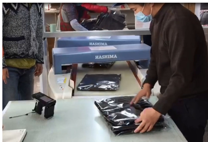
写真 4：検針工程後の電子タグ読み取りの様子
