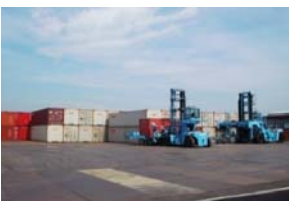
荷役機械(トップリフター)
