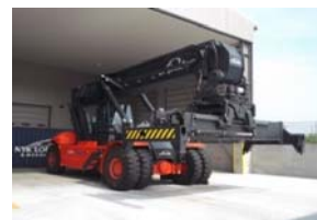
荷役機械(リーチスタッカー)
