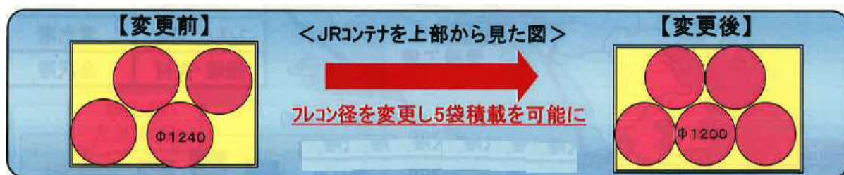
図 18 既存フレコンの径の見直しイメージ
