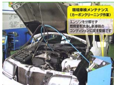
燃焼室洗浄・オイルラインシステム洗浄（資料提供(株)サンオータス）
